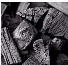
**Древесный уголь** в смеси с серой и селитрой используется в качестве **черного пороха**. **Сажа** как мелкокристаллическая модификация углерода входит в состав резины, идущей на производство разнообразных резинотехнических изделий, используемых в различных видах военной техники: автомобильной, бронетанковой, авиационной, артиллерийской, ракетной и т.д. Одним из самых
