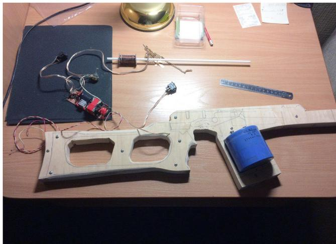
Делаем пропилы по схеме. При этом вносим изменения: расширяем магазин под конденсатор-накопитель, делаем отверстия под выключатели и кнопки. Чтобы минимизировать схему, переменный резистор меняем на обычное сопротивление.
