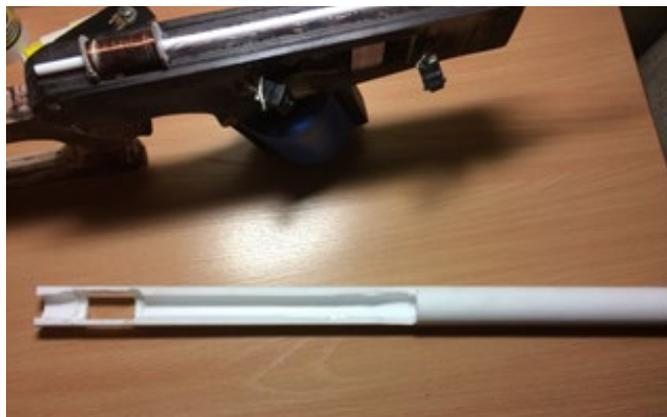
Поверх трубки, из которой вылетает пуля, для придания более реалистичного вида винтовке решено сделать ствол. Тут я использовал обычную трубку из полихлорвинила.
